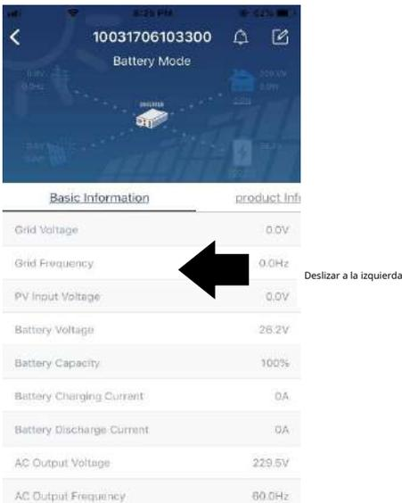
**[Información básica]** muestra información básica del inversor, incluido voltaje CA, frecuencia CA, PV voltaje de entrada, voltaje de la batería, capacidad de la batería, corriente de carga, voltaje de salida, frecuencia de salida, potencia aparente de salida, potencia activa de salida y porcentaje de carga. Deslice hacia arriba para ver más información básica.
